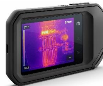
赤外線サーモグラフィー (-20~400℃)
