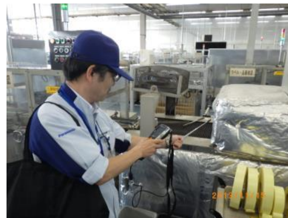
接触型温度計による測定
