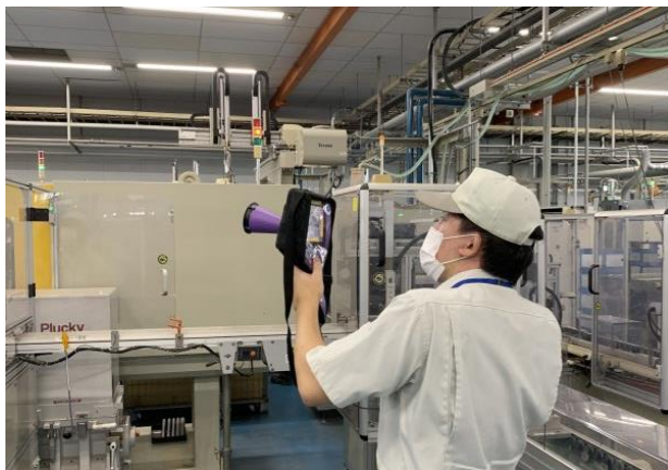
エアリーク可視化カメラで漏れ調査
