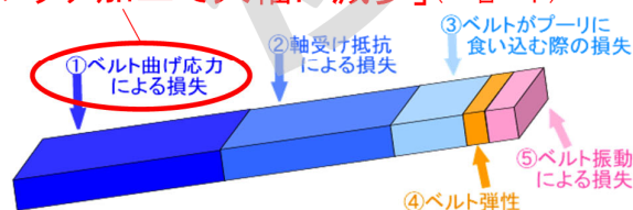
図1 Vベルトによるエネルギー損失(内訳)
