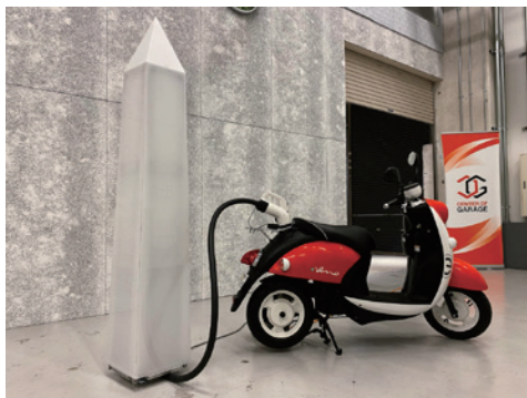
電動バイク用「急速充電用バッテリーモジュール」と、 電力の増幅出力が可能な「急速充電ステーション」
