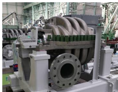
RO 海水淡水化プラント向け 高圧海水供給ポンプ
