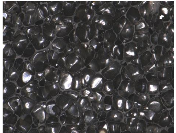
フロート断面拡大写真 約 100 倍 (内部独立気泡構造)
