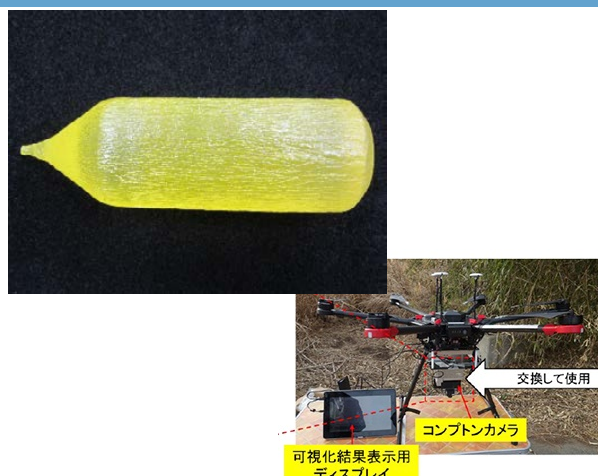
同社製品の「GAGG」とそれを検出器に用いた「ドローン搭載型コンプトンカメラ*2」
