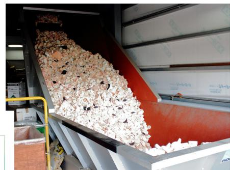
型取りで出るスポンジやゴムの端材や規格外品などをサーマルリサイクル燃料とする廃ゴム燃料化システム(写真は破碎された原料)を開発し活用するなど、サーキュラーエコノミーにも積極的に取り組んでいる
