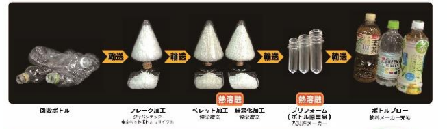
回収 PET ボトルから飲料ボトルを作る 世界初『FtoP ダイレクトリサイクル』技術
