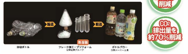
回収 PET ボトルから飲料ボトルを作る 世界初『FtoP ダイレクトリサイクル』技術
