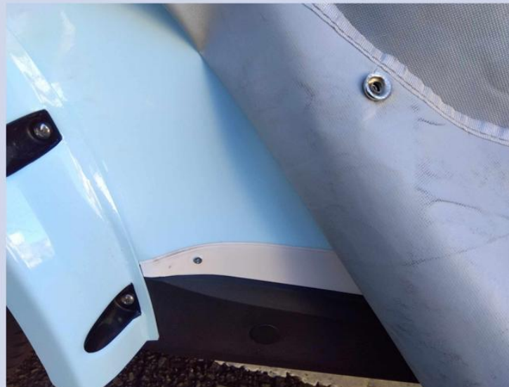
カーテンボタン脱落
