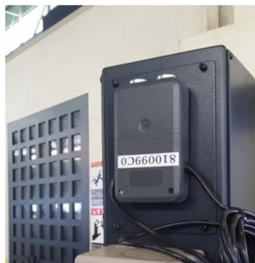
光センサのデータを取得し、無線でデータを送信する機器
