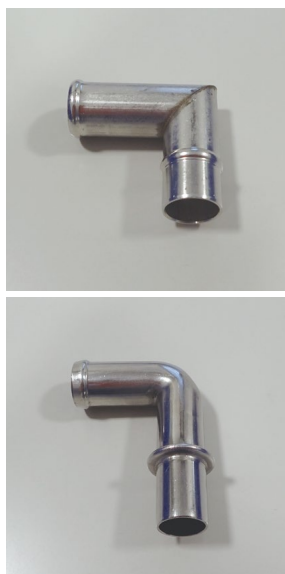
従来部品（溶接で複数品を溶接したもの）と一体曲げ加工した部品
