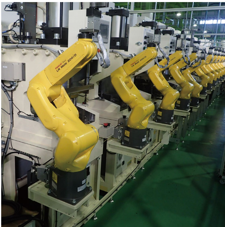
導入されたパイプ加工用のロボット
