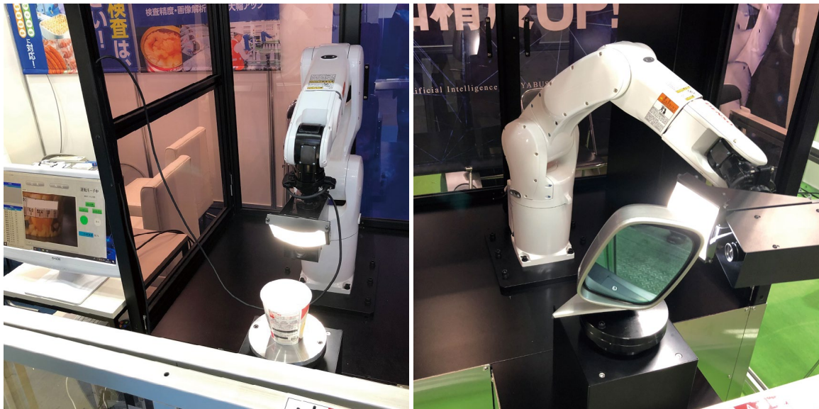
AIと画像処理技術およびロボットを活用した検査
