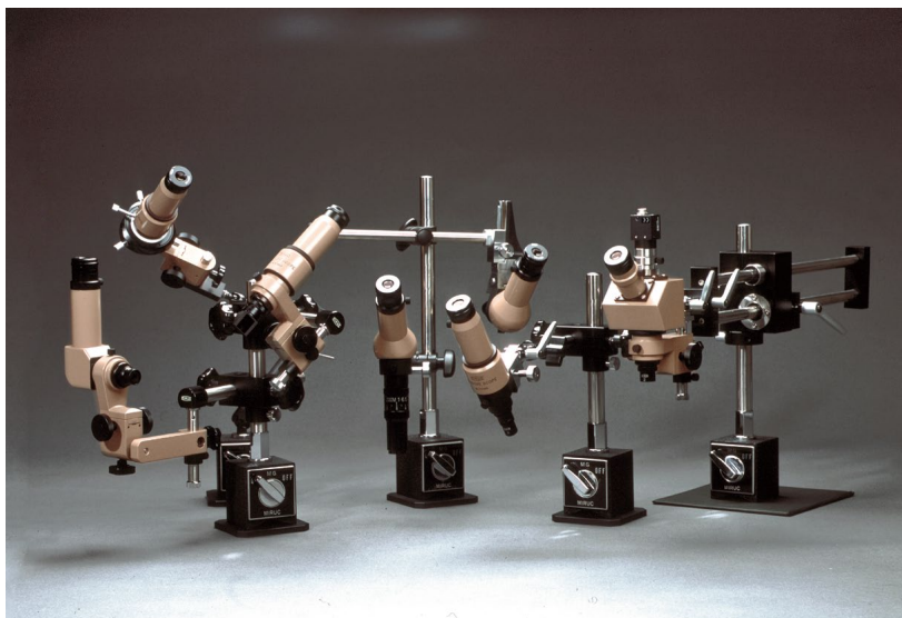
ミラック光学の製品であるアリ溝式ステージ（マルチジョイントステージ）とメジャースコープ
