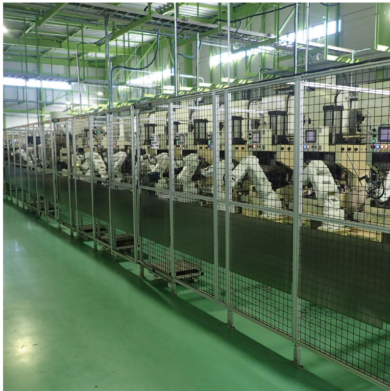
ロボットにより自動化されたパイプ加工ライン
