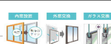
断熱窓への改修
