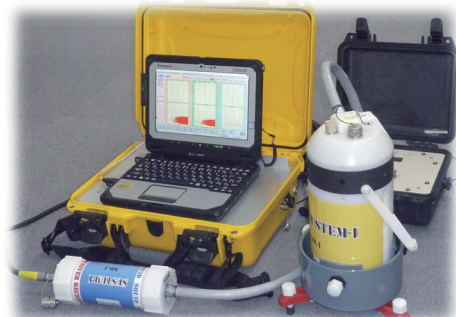
超高感度なSQUID磁気センサシステム
