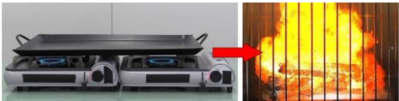
カセットこんろを 2 台並べて使用して破裂
