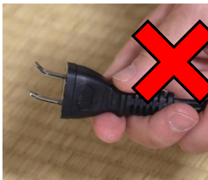
変形した電源プラグは使用しない
