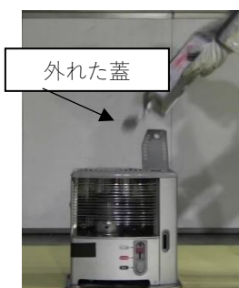
(写真) 消火後間もない高温の燃焼筒に灯油がかかり引火 (イメージ)
